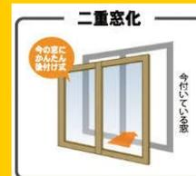
窓まわりは熱が逃げやすいため内窓を設置したり天井、床の断熱改修で外気温の影響を最少限に抑えることができます。サッシの内側に付ける樹脂製の窓で簡単に取り付けられ大きな断熱効果があります。
